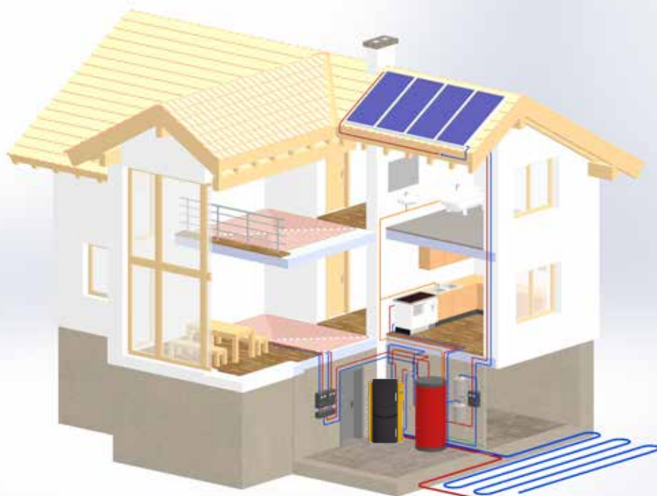
Fig.: image en coupe d'une maison avec cuisinière à chauffage intégrée
