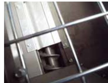
Fig.: Vis sans fin dans le réservoir à pellets
